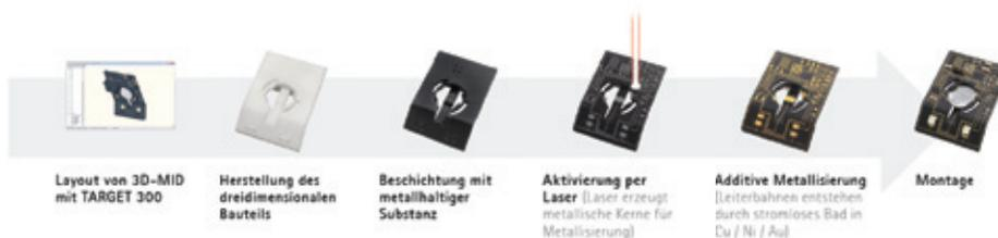
Herstellungsschritte von Mechatronic Integrated Devices (MID) per Laser-Direktstrukturierung (Quelle: Beta LAYOUT)
